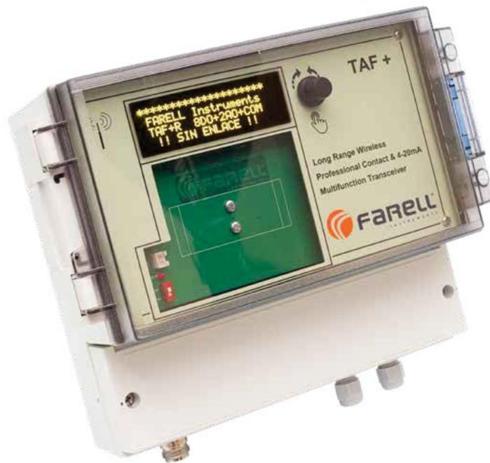
El telemando TAF envía los cambios de estado de contactos eléctricos (alarmas y ordenes remotas) vía radio, a larga distancia (hasta 30 Km) y con gran robustez frente a interferencias. Sistema punto a punto con emisor y receptor de 2 a 8 canales.
